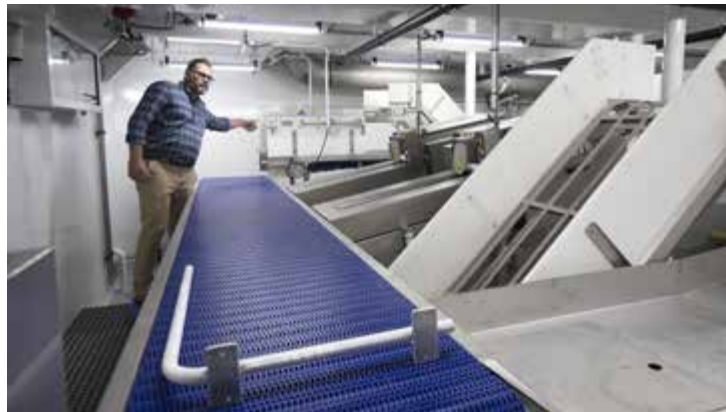
André Rustad er daglig leder for GOT Marine, det tidligere Skogsøy Båt. Her viser han fram litt av «fiskefabrikken light» under dekk på Risvik av Vardø. Langs båndet kommer fisken inn, deretter behandles den og sendes videre ned i kjølerom. FOTO: KJARTAN BJELLAND
